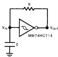
$$t_2 \approx RC \ln \frac{V_{CC} - V_{T-}}{V_{CC} - V_{T+}}$$
